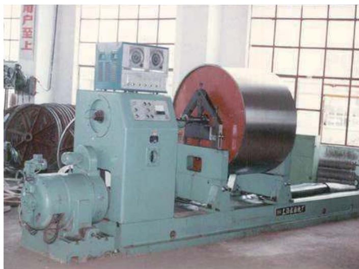
梳棉机锡林在做动平衡检测
